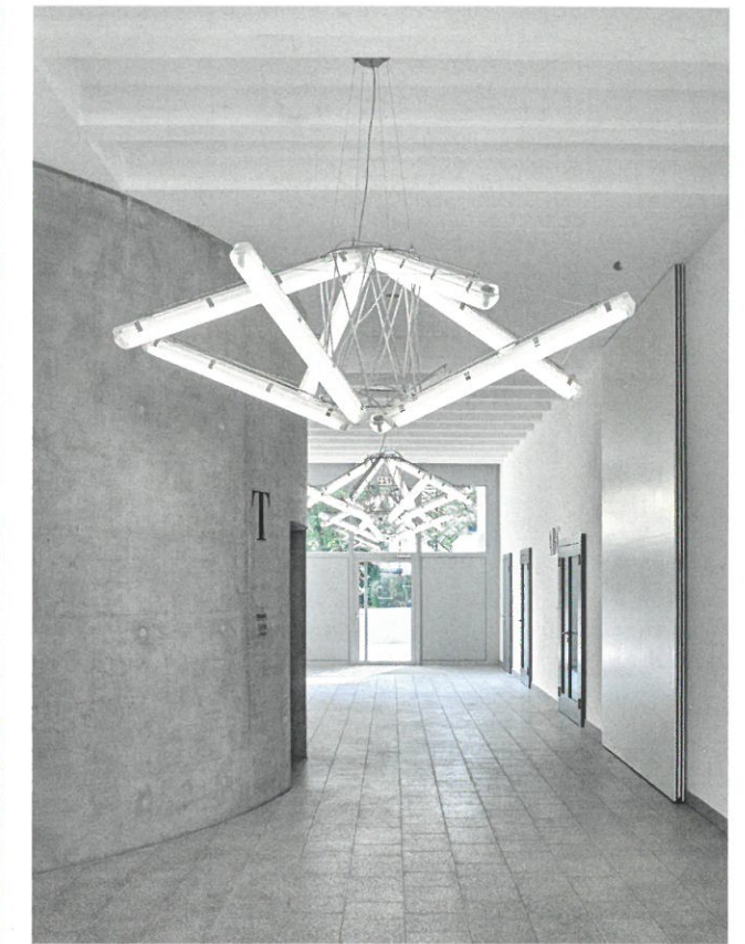
Durchgehende Eingangshalle zwischen dem Turm und dem Werkstattgebäude: Die Fluoreszenz-Stableuchten, die in den anderen Erschliessungsräumen vertikal montiert sind, wurden hier zu einer Art Kronleuchter kombiniert.
